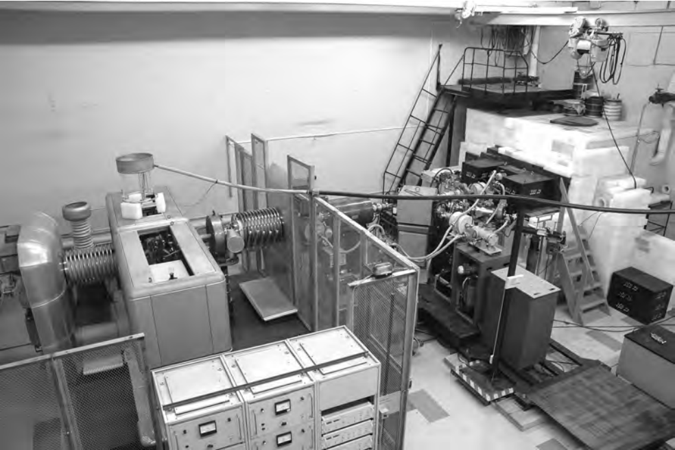
Генератор 14 МэВ нейтронов в Уральском центре нейтронной терапии
