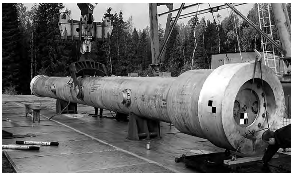
Транспортный упаковочный контейнер для хранения и перевозки отработанного ядерного топлива
